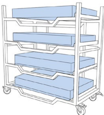
Abbildung 3: Rack mit vier Hochvoltspeichern © EVA Fahrzeugtechnik GmbH
