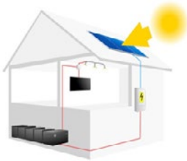
Abbildung 2: Beispielhafte Darstellung eines B2L-Batteriespeichers für ein Einfamilienhaus © Fotolia.com
