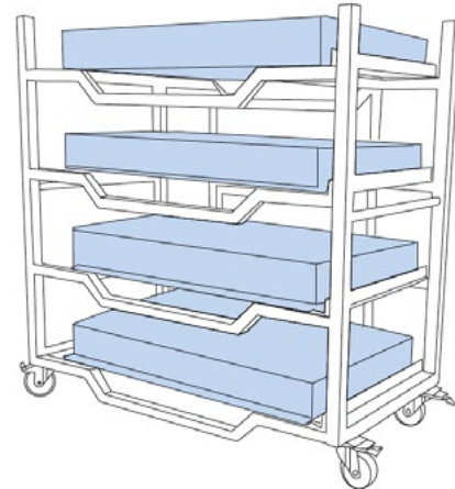
Abbildung 5: Gebrauchte Elektrofahrzeug-Hochvolt-Speicher von vier Fahrzeugen als stationärer Gesamtspeicher in Rackbauweise Quelle: EVA Fahrzeugtechnik
